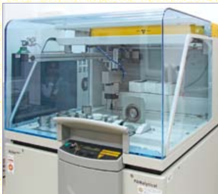
Fot. 6. Spektrometr fluorescencji rentgenowskiej WDXRF (Foto: M. Chmiel)
