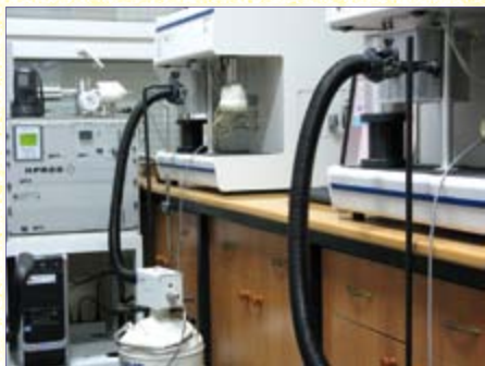
Fot. 11. Aparatura do badań temperaturowo-programowanych (Foto: A. Machocki)
