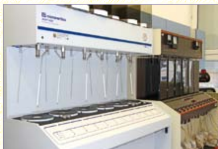
Fot. 8. Aparatura do badań adsorpcyjnych (Foto: M. Chmiel)
