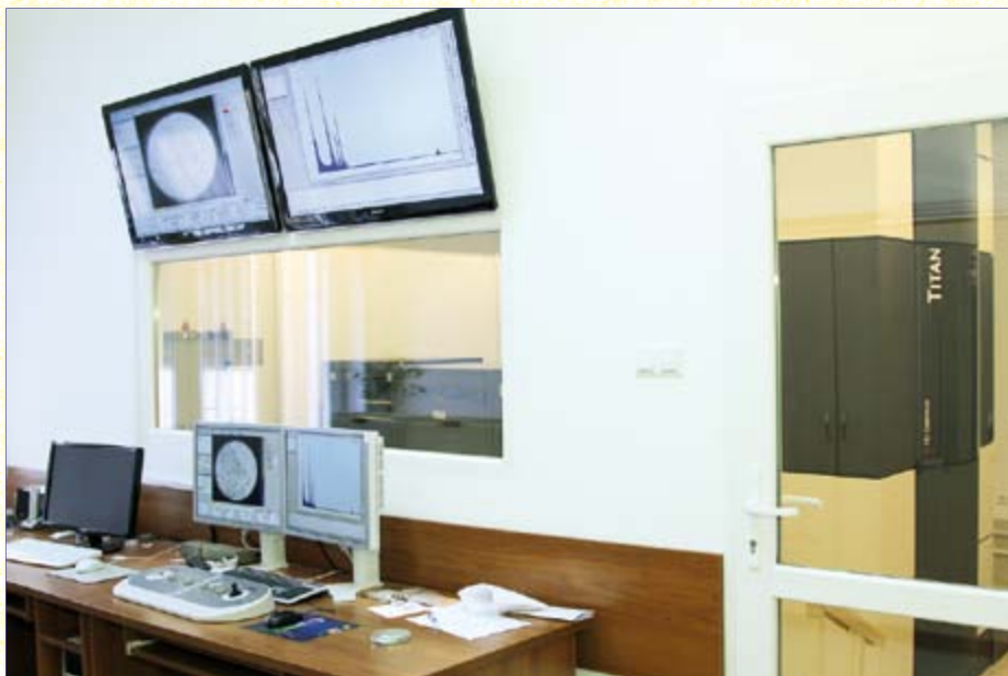
Fot. 2. Pokój operatora transmisyjnego mikroskopu elektronowego (Foto: M. Chmiel)
